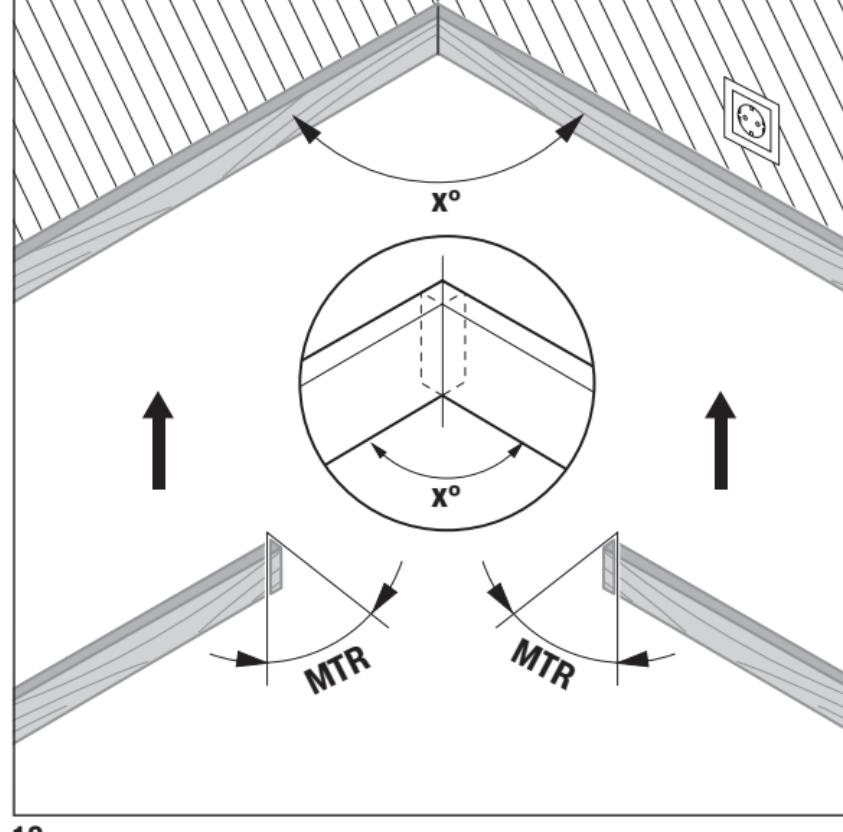
L'angle d'onglet « **MTR** », par lequel les deux ouvrages doivent être raccourcis, est calculé. Pour ces coupes d'onglets, la lame de la scie est verticale par rapport à l'ouvrage (l'angle de biseau est de 0°).
