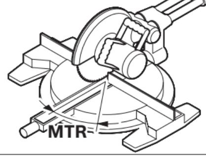
Presione de nuevo el botón **15. “MTR”** y el ángulo de inglete calculado para la sierra troceadora e ingleteadora se indicarán en la pantalla.
