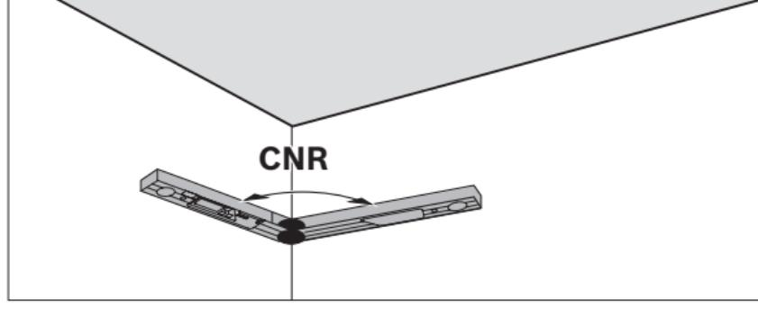
Pour mesurer l'angle de coin, placez le pied pliant et le pied de la base à plat contre les murs et lisez l'angle de coin mesuré ou paramétrez un angle de coin connu sur le mesureur d'angle.
