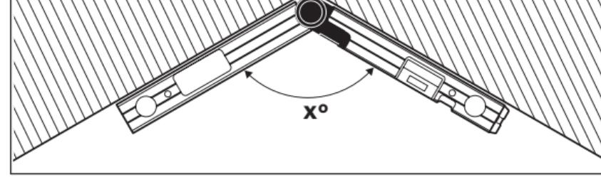
Lorsque des ouvrages doivent être placés dans un coin (p. ex., dans le cas de l'éboutage pour un plancher), mesurez l'angle de coin **x°** en appliquant le pied pliant et le pied de la base. Pour des angles donnés (p. ex., des cadres pour tableaux), ouvrez le pied pliant et le pied de la base jusqu'à ce que l'angle désiré soit indiqué sur l'affichage.
