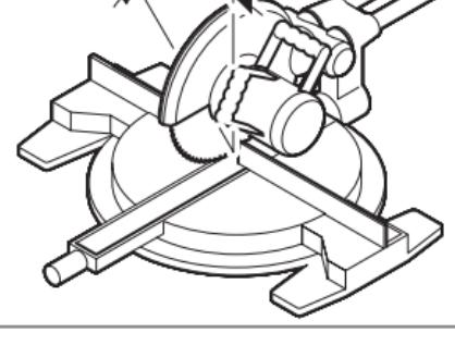
Presione de nuevo el botón **15. “BVL”** y el ángulo de bisel calculado para la sierra troceadora e ingleteadora se indicarán en la pantalla.
