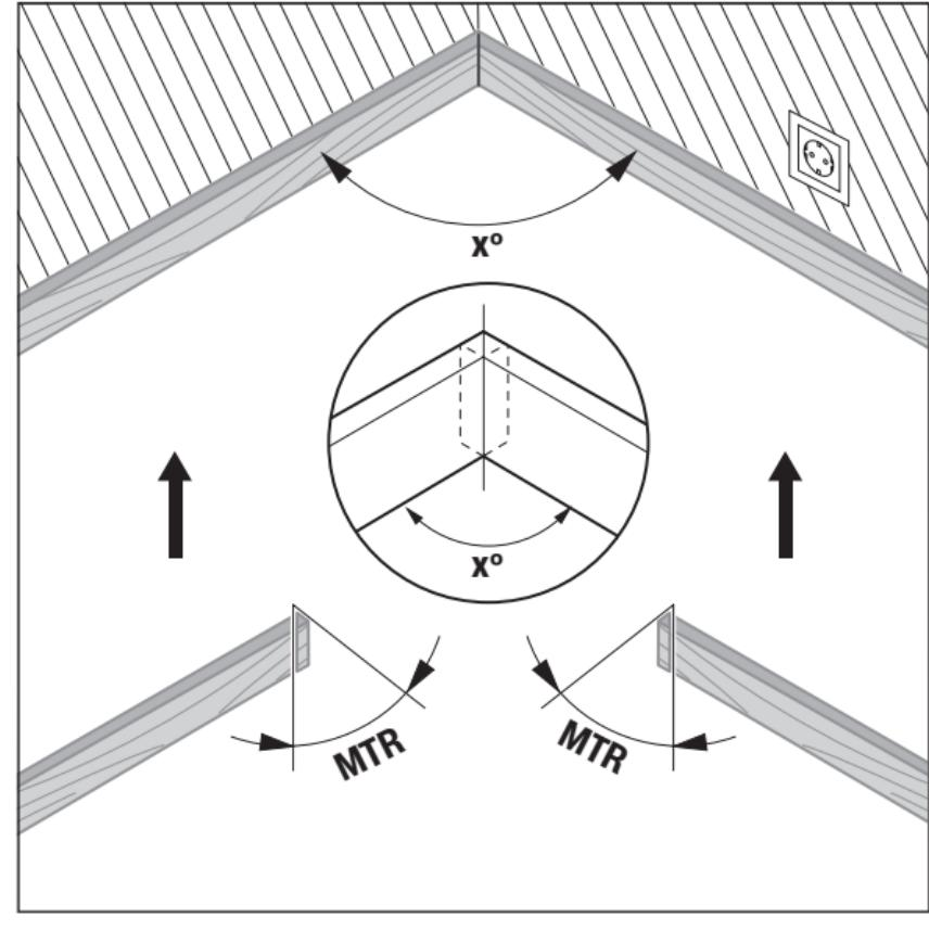
Se calculará el ángulo de inglete “**MTR**” en cuyo valor se van a acortar las dos piezas de trabajo. Para estos cortes a inglete, la hoja de sierra estará vertical respecto a la pieza de trabajo (el ángulo de bisel será 0°).
