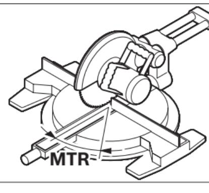
Appuyez sur le bouton **14**. L'angle d'onglet horizontal calculé « **MTR** », qui doit être paramétré sur la scie à déchiqueter/scie à onglet, et l'indicateur « **MTR** » seront affichés sur l'écran.
