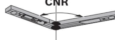
Para medir el ángulo de esquina, coloque la pata desplegable y la pata de la base en posición plana contra las paredes y lea el ángulo de esquina medido o ajuste un ángulo de esquina conocido en el localizador de ángulos.
