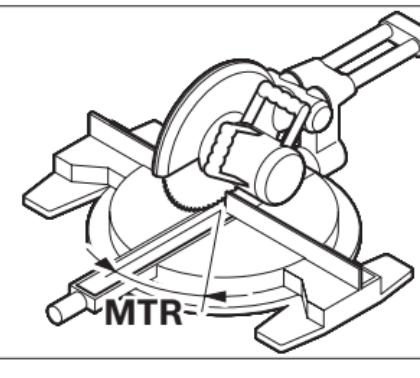
Presione el botón **14**. El ángulo de inglete horizontal calculado “**MTR**”, que se tiene que ajustar en la sierra troceadora e ingleteadora, y el indicador “**MTR**” se mostrarán en la pantalla.
