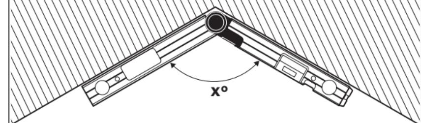
Cuando las piezas de trabajo se vayan a encajar en una esquina (p. ej., para molduras de piso), mida el ángulo de esquina **x°** aplicando la pata desplegable y la pata de la base. Para ángulos determinados (p. ej., marcos de cuadros), abra la pata desplegable y la pata de la base hasta que el ángulo deseado se indique en la pantalla.
